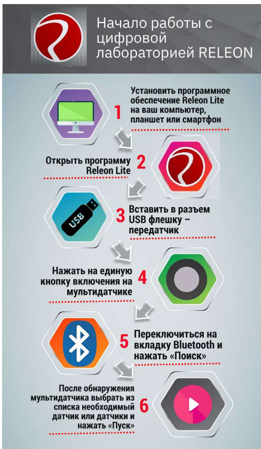
Рис. 14. Алгоритм работы с программным обеспечением Releon Lite
